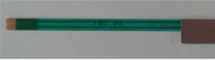
抵抗膜式センサで、触れているかどうかを検出します。検出領域のデザインフリー（大きさ、形状）。従来製品で実現し得なかった薄型形状が実現可能です。一定の防水性能を実現可能です。
